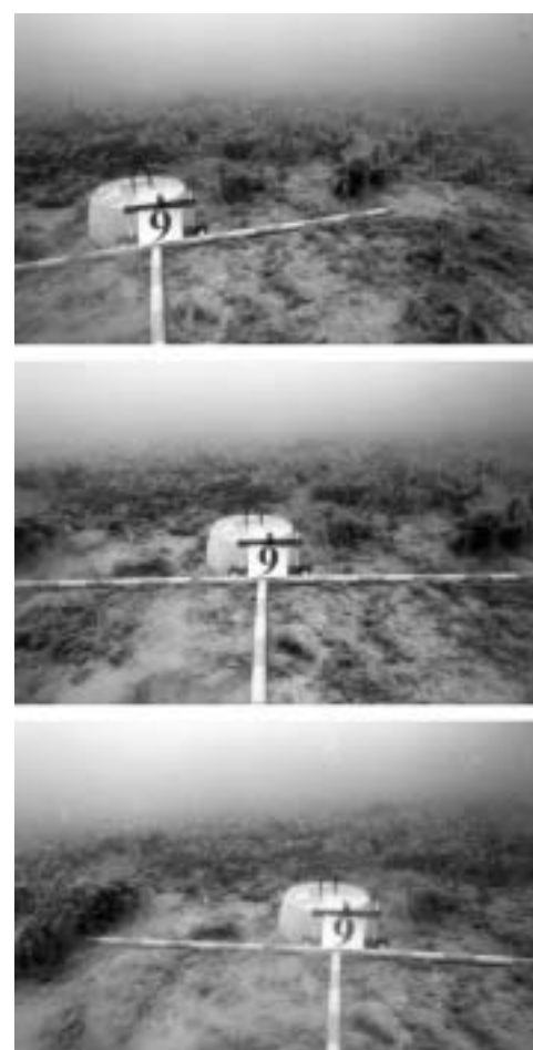
Fig. 129. La balise n° 9, à la limite inférieure de l'herbier à Posidonia oceanica , à Golfe-Juan (Alpes-Maritimes, France), 31m de profondeur. 3 photos (décentrée à gauche, centrée, décentrée à droite) sont prises lors des plongées de suivi. Photos A. Meinesz.
