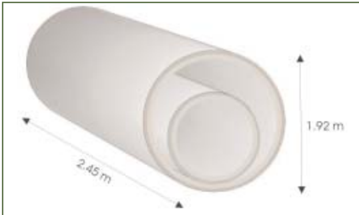
Fig. 91. Schéma d'un récif artificiel de protection anti-chalutage utilisé dans la Région Languedoc-Roussillon (France). D'après Collart et Charbonnel (1998).
