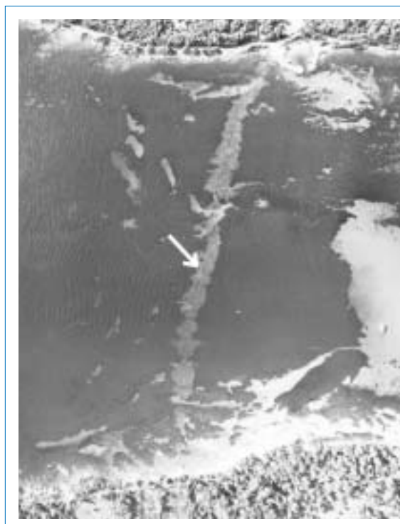
Fig. 111. Tranchée ouverte dans l'herbier à Posidonia oceanica pour le passage d'un câble électrique (flèche). Îles de Lérins (Alpes-Maritimes, France). Photo Aerial®.
